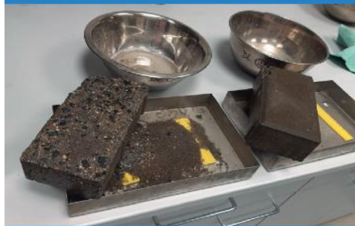
Rozdíl v odpadu neošetřené a ošetřené dlažby po 50 zmrazovacích cyklech
