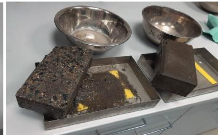
Rozdíl v odpadu neošetřené a ošetřené dlažby po 50 zmrazovacích cyklech
